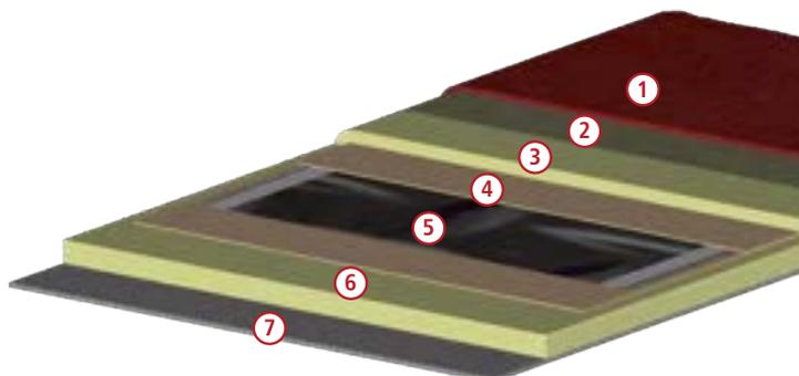
Unsere rutschfesten Kirchenbankpolster mit integriertem Flächenheizleiter Thermotex ca. 73 Watt pro Laufmeter - 230 Volt Schutzklasse II (Vollschutzisoliert) Patentnummer: 10 2004 011 128
